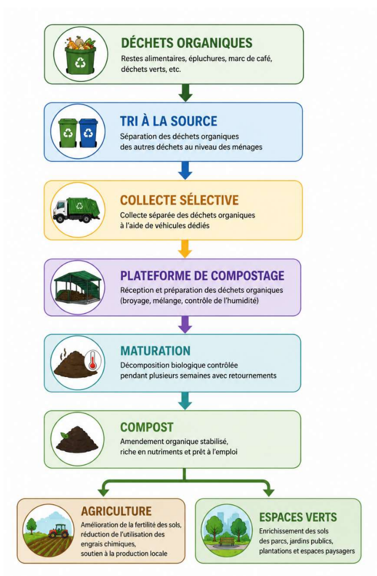
Figure 27 : Schéma de la filière de compostage proposée pour la valorisation des déchets organiques à M'Sila.
