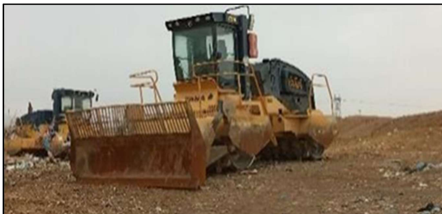
Figure 20 : Compacteur utilisé pour le tassement des déchets.
