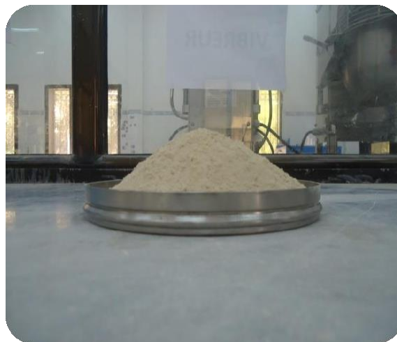
Figure II.5: sable de dune finement broyé
