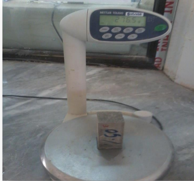
FigureIV.10 : Mesure la masse de l'éprouvette saturée
