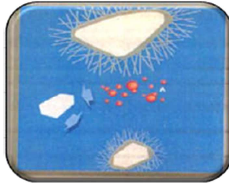
Figure I.6 : Effet de la fumée de silice sur la réaction d'hydratation [43]
