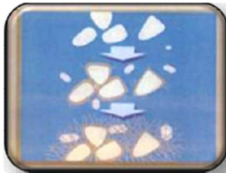
Figure I.2 : Effet de la fumée de silice sur l'hydratation du ciment [43]
