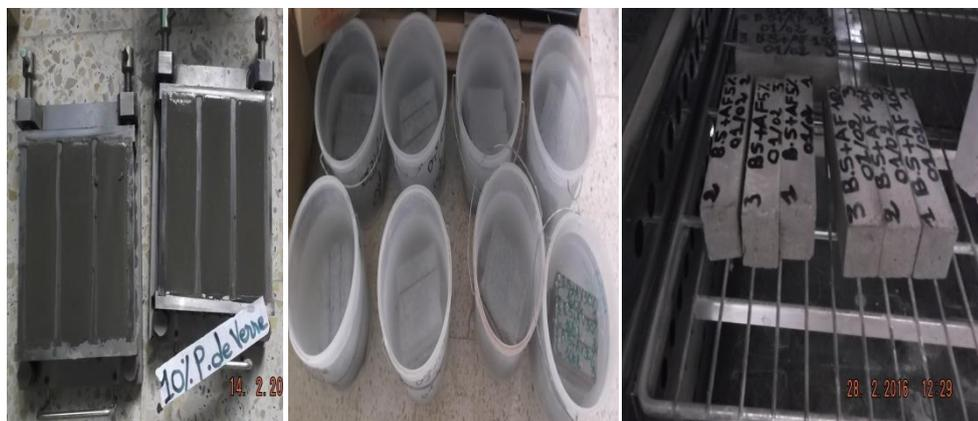
Figure(2.5) :conservation des éprouvettes.
