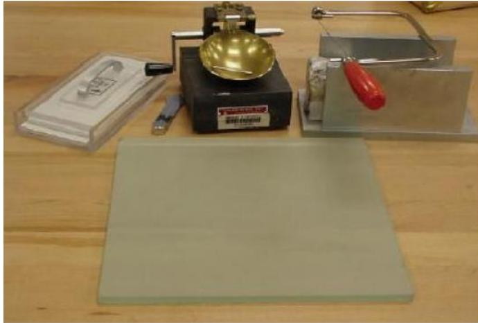
Figure I.2. L'appareil de casagrande
