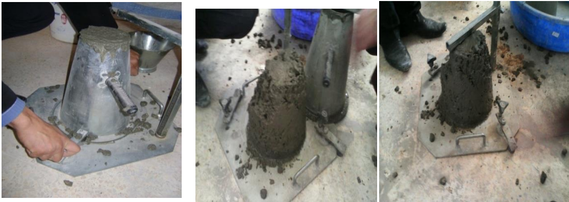
Figure II.8. Essai d'affaissement au cône d'abrams
