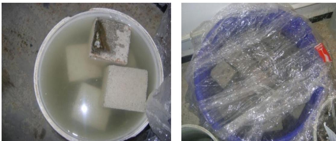
**Figure.III.3.**Eprouvettes cubiques 10x10x10mm<sup>3</sup> immergées dans la solution d'acide sulfurique
