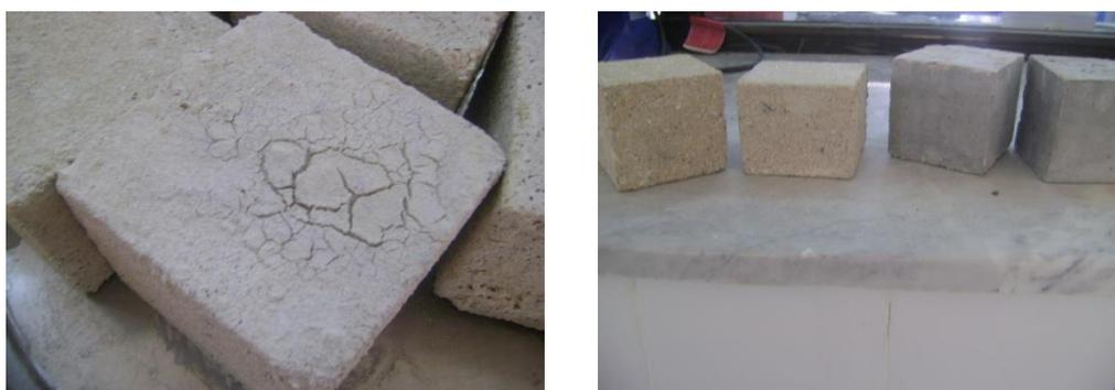
**Figure III.5.**Béton 2(cure 28j) après 21 jours d'immersion dans l'acide sulfurique
