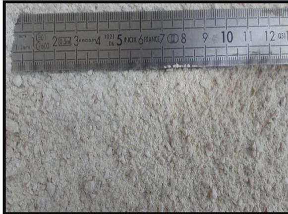
**Figure II.6:** Diamètre de sable de carrière
