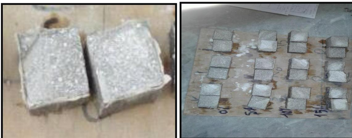
**Figure II.10:** Coupe de l'éprouvette en deux après 28,56 et 90 jours d'immersion (totale).
