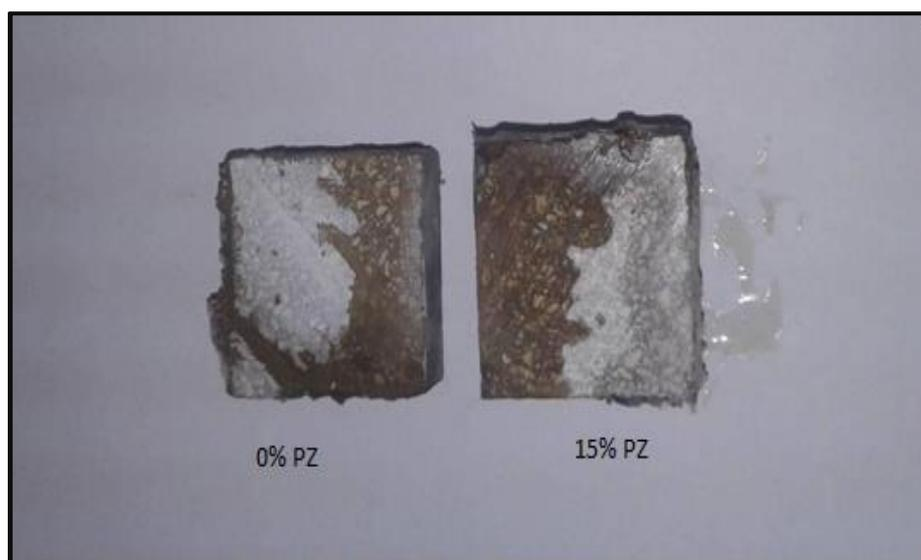
**Figure II.12:** Mesure de la profondeur de pénétration d'ion chlore
