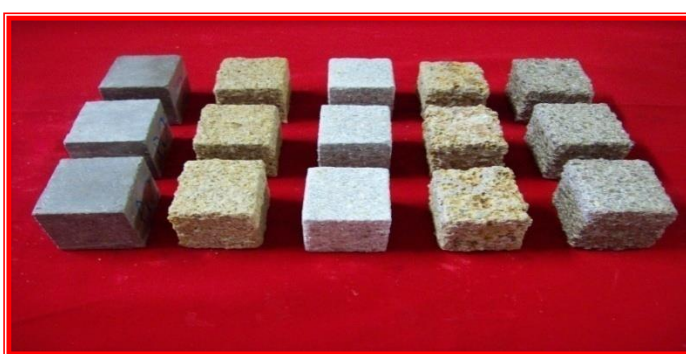
Figure I.18: Etat des éprouvettes après immersion de 28 jours dans l'eau milieu neutre, 3 % HCl, 3% H 3 PO 4 , 3% HNO 3 et 3% H 2 SO 4 ( de gauche à droite)
