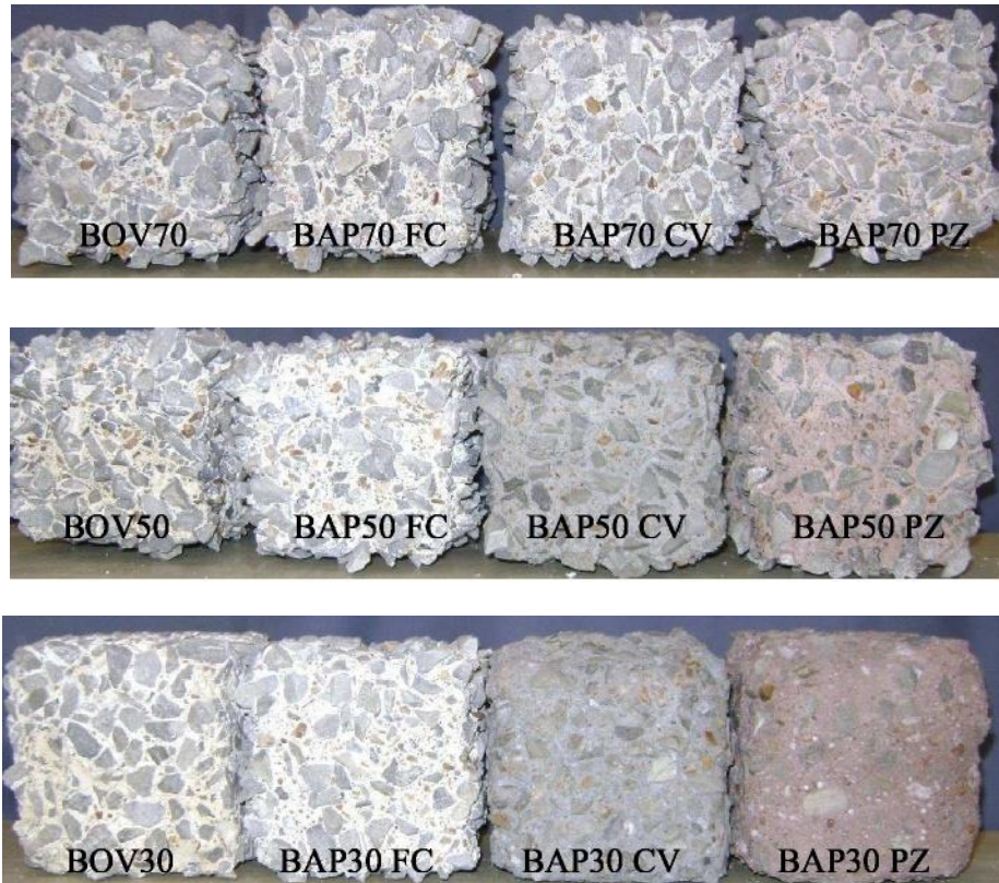
Figure 1.15: Dégradation des échantillons du béton après 12 semaines d'immersion dans la solution d'acide sulfurique.
