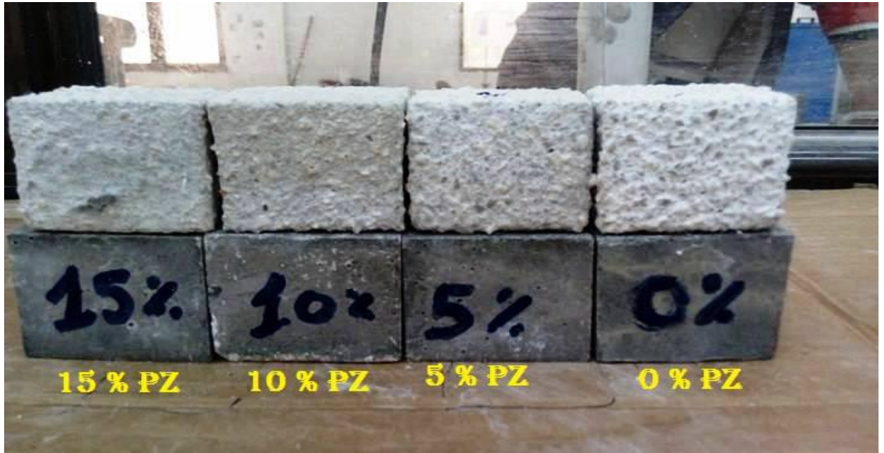
Figure III.19. Photos des éprouvettes du MAP après 56 jours d'immersion dans 5% H_2SO_4
