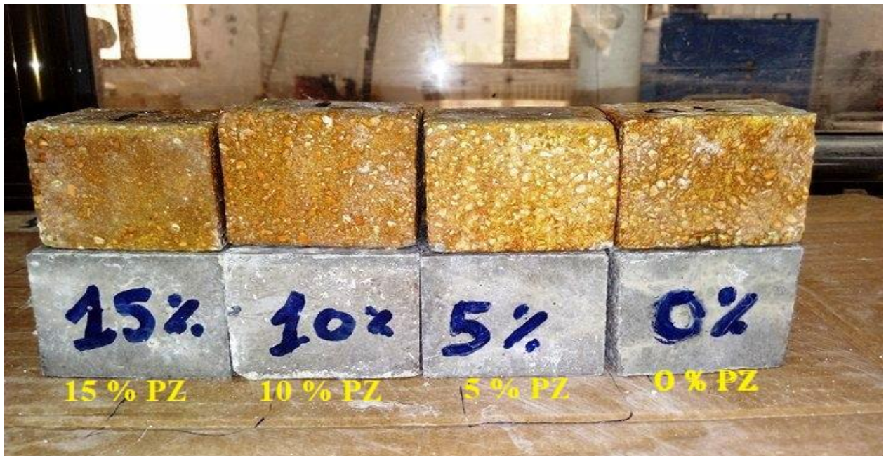
Figure III.20. Photos des éprouvettes du MAP après 56 jours d'immersion dans 5% HCL
