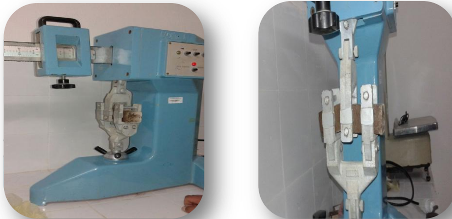
Figure III.11. Appareille de traction par flexion (LNHC).
