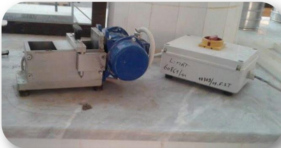
Figure III.8 : Appareille de Maniabilimètre (Université de Djelfa).
