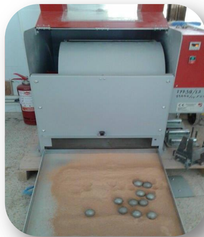
Figure III-4 : Utilisation de los Angeles pour broyage de MT.
