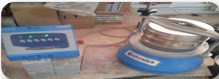
Figure III.2 : Opération de tamisage du sable.
