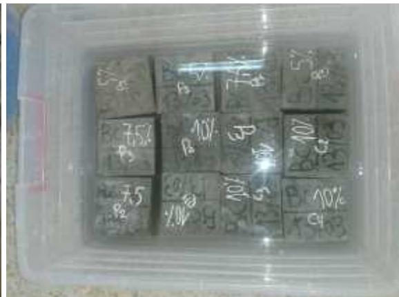
**Photo N°011 :** les éprouvettes immergées
