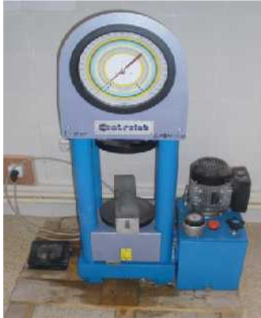
**Photo N°09 :** La presse hydraulique de compression pour béton.
