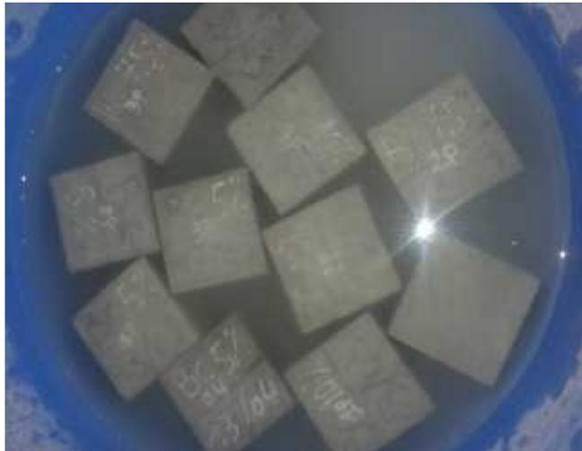
Photo N° 08 : Cure des éprouvettes sous l'eau à chaux
