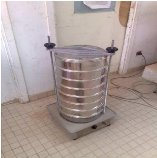
Figure II.1 : Les tamis de l'analyse granulométrique.
