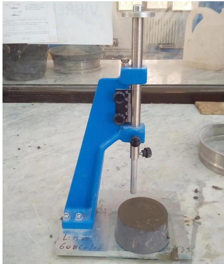
Figure III.1 : L'appareil de Vicat
