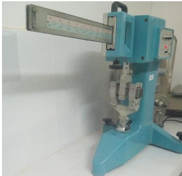
Figure II.7 : Appareil de flexion 3 points
