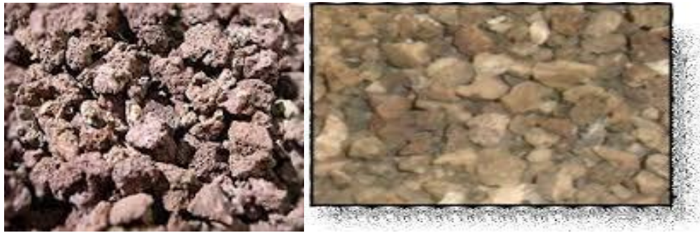
Figure 7: La pouzzolane naturelle ou artificielle
