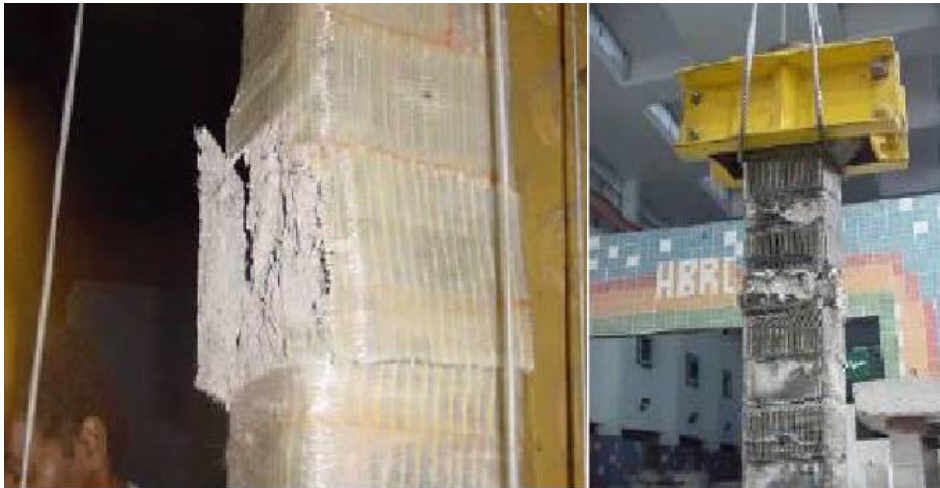
Figure I.9 : confinements d'un poteau au moyen de PRFC
