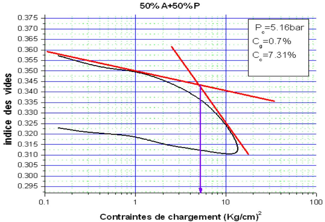
**La Bentonite de Maghnia et la fraction volumique de la poudrette de caoutchouc des pneus usés**
