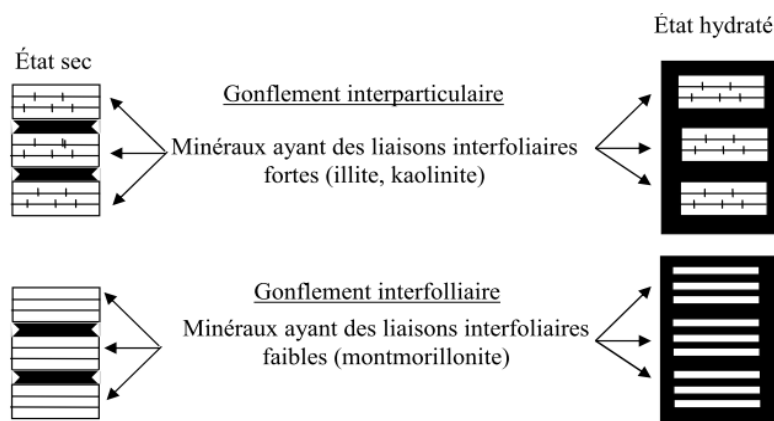
Fig.1.15. Mécanismes de gonflement des argiles par hydratation [MOU88]
