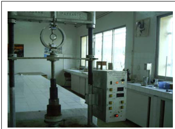
Figure V.3: Presse d'écrasement avec éprouvette duriez en place
