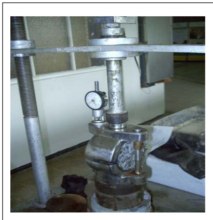
Figure V.6: Presse d'écrasement avec éprouvette Marshall en place
