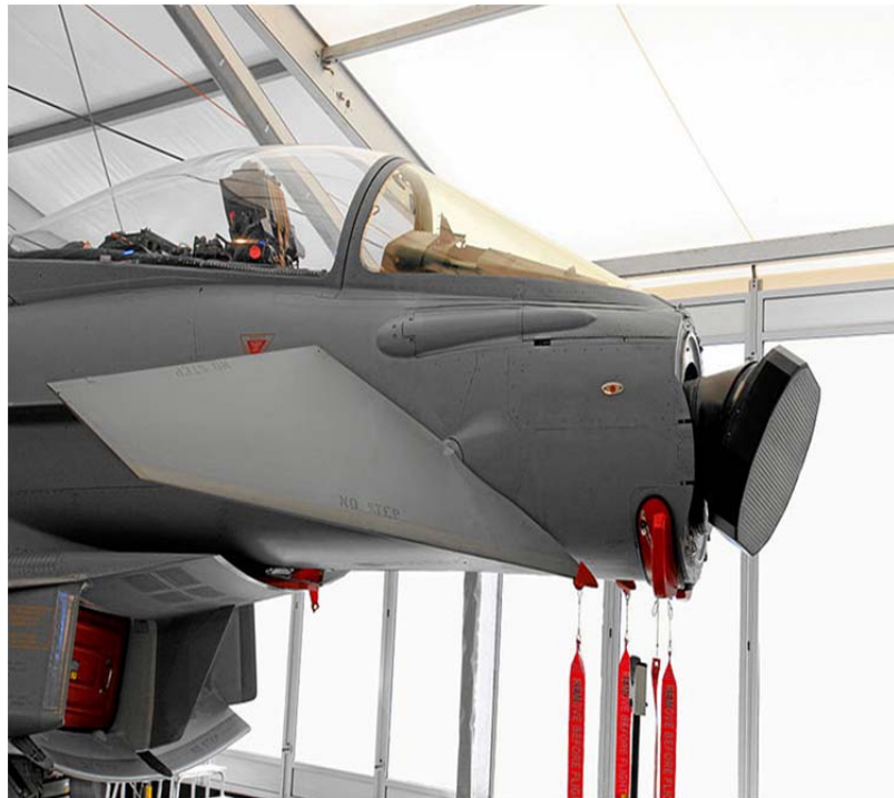
Fig. 1.9. Avion de chasse (Eurofighter Typhoon), équipé d'une antenne active encastrée dans son radome
