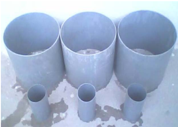
a) Formes du papier plastique utilisé pour provoquer les fissures. b) les moules de traction directe et de fendage.
