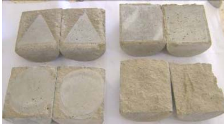
Fig. V.11 : Éprouvettes après rupture par fendage.
