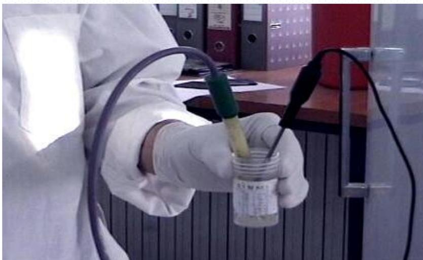
**Figure X : Photographie de l'étalonnage de conductimètre**
