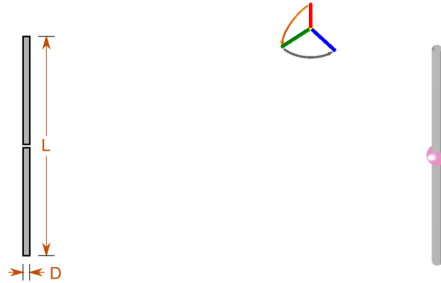
Fig. 2.3. Structure d'antenne dipôle simulée.
