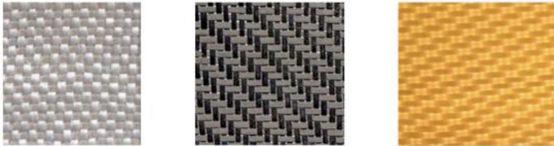
Figure 1.3. Exemples de tissus de renforts utilisés pour les CMO haute performance [35] : (a) verre, (b) carbone, (c) aramide (Kevlar).
