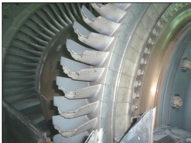
Figure II.17: Usure des ailettes du compresseur axial
