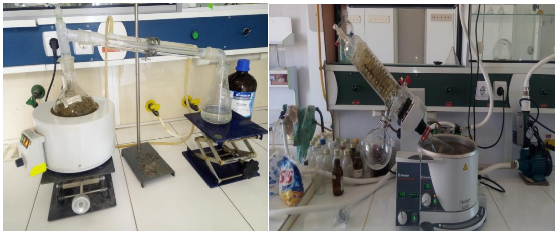
Montage d'hydrodistiation de Cistus villosus Évaporation Rotative de Cistus villosus
