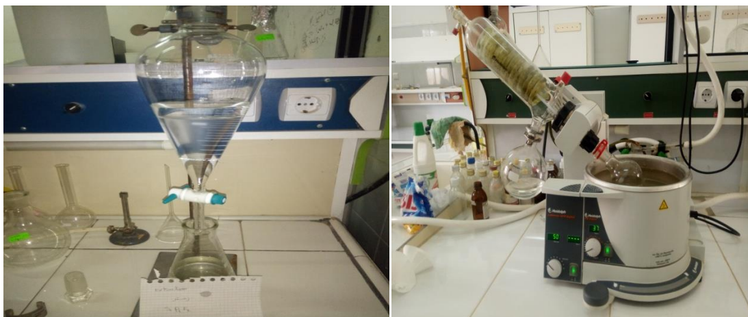
Extraction liquide-liquide de Thymus vulgaris Évaporation Rotative de Thymus vulgaris
