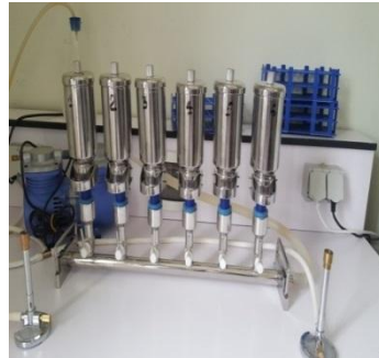
photo 2 : Rampe de filtration
