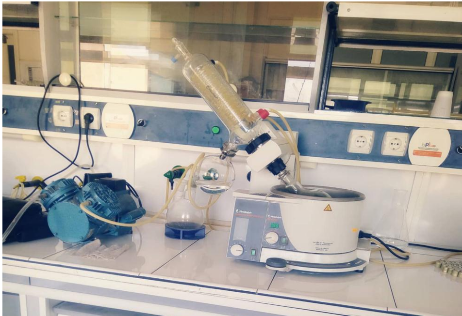
Figure 14 : Evaporation du filtrat par un rotavapeur sous vide(photo personnelle)
