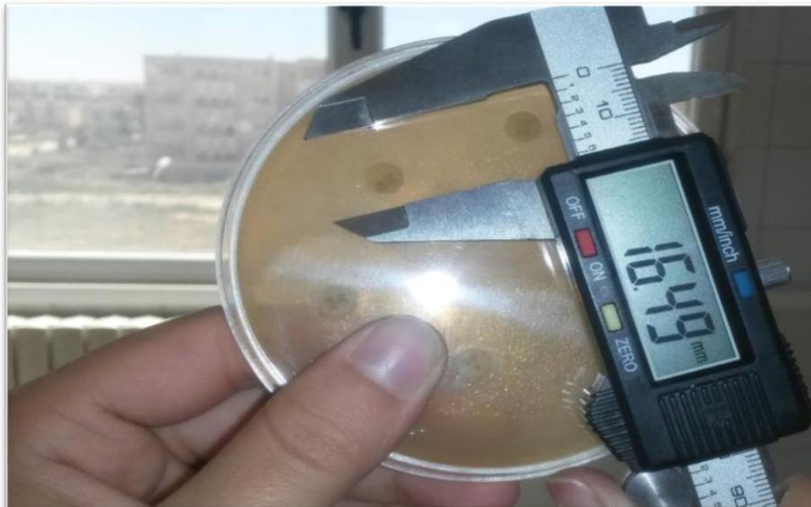
**Figure 10** : Mesure des diamètres des zones d'inhibition avec pied de coulisse (Originale, 2019).
