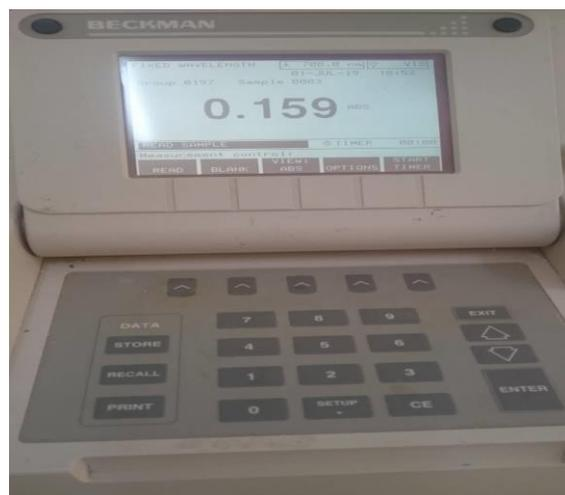
Spectrophotomètre (700 nm)
