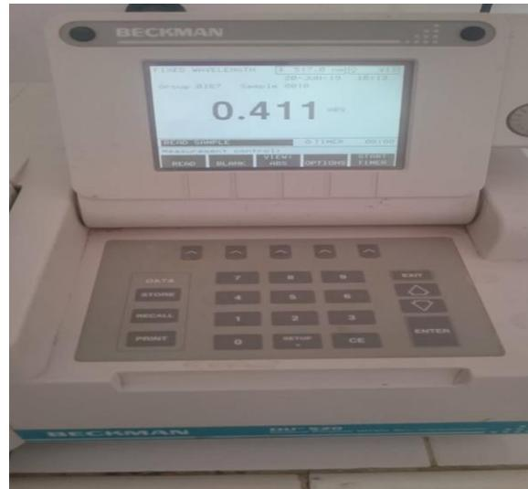
Spectrophotomètre (517 nm)
