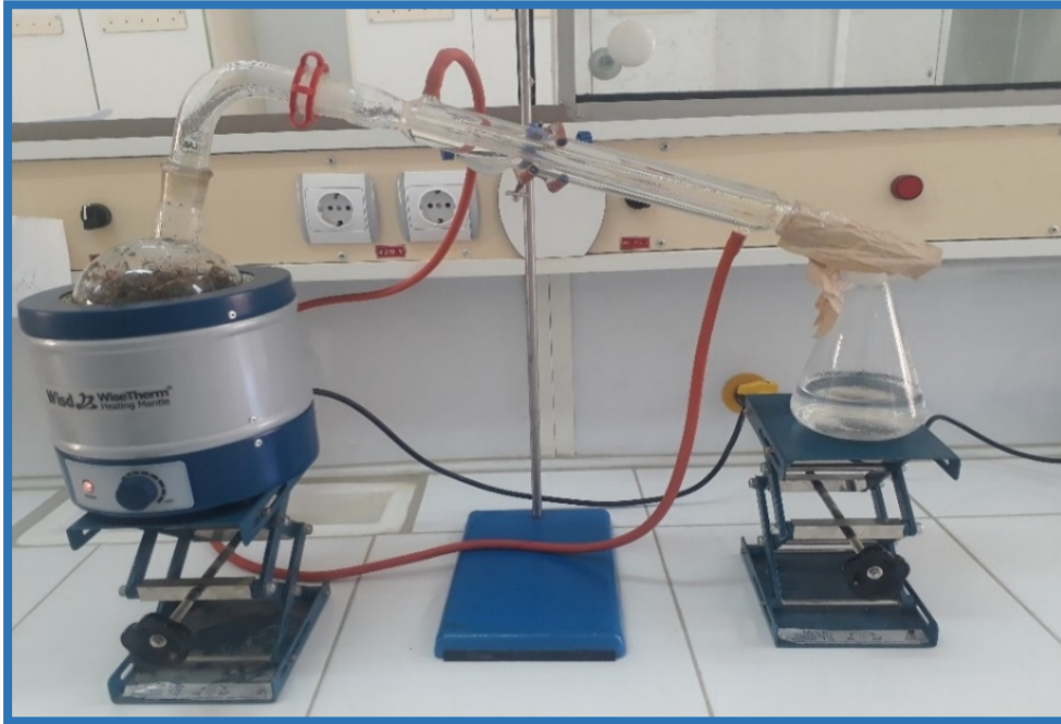
Figure 15 : Montage d'hydro-distillation (appareil de type Clevenger)
