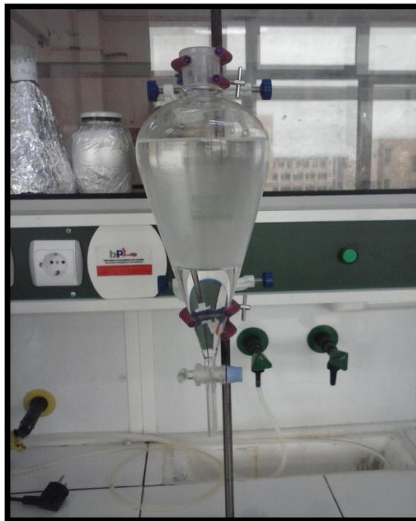
**Figure II.2. Montage de l'extraction liquide-liquide.
