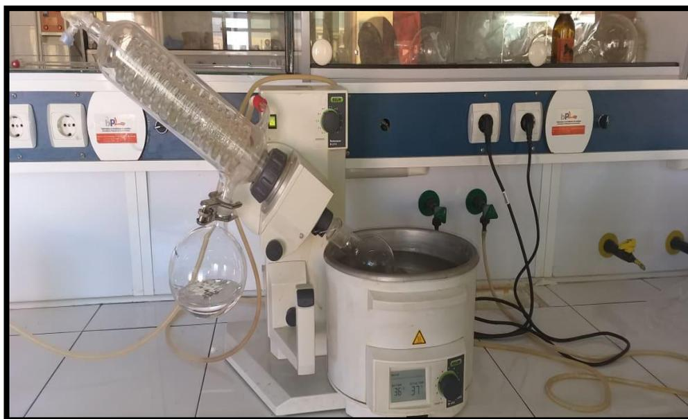
**Figure II.3. Evaporateur rotatif (photo originale)**
