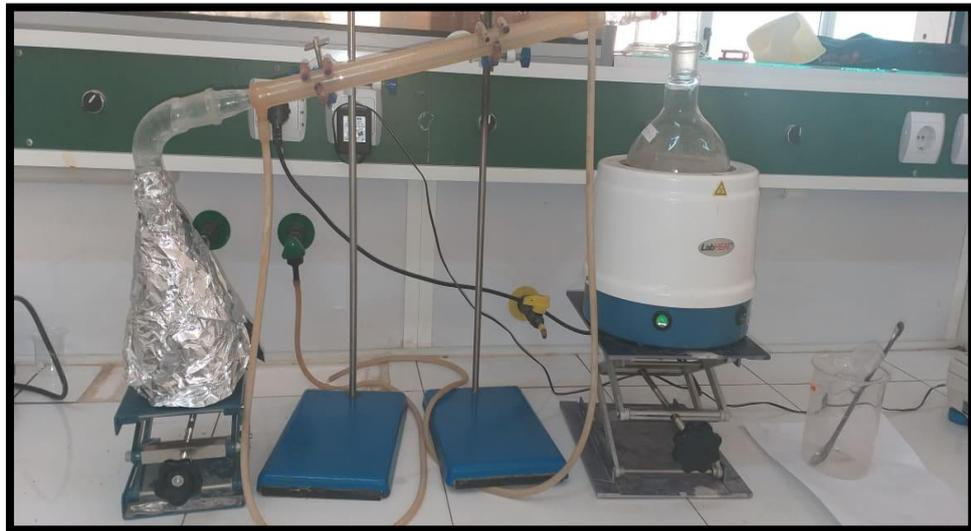
**Figure II.1. Dispositif d'hydrodistillation.**
