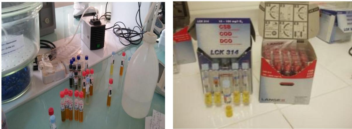
Figure 13 : le matériel d'analyse de la DBO et DCO.
