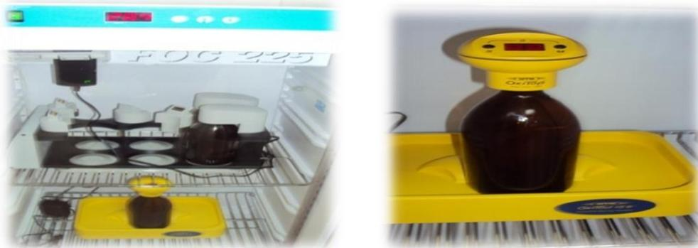
Figure 16 : DBO-mètre et Oxitop (Photos originale).
