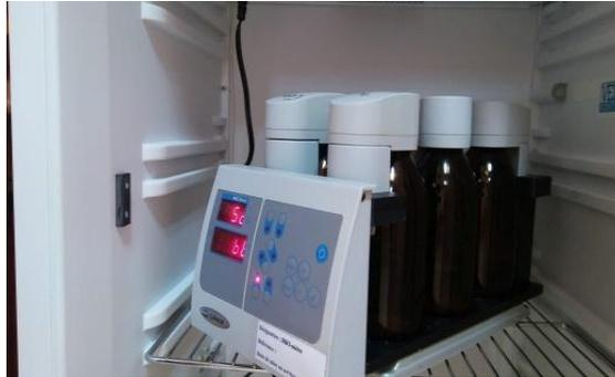
Figure 15: Incubateur + DBO-mètre (Photos originale).
