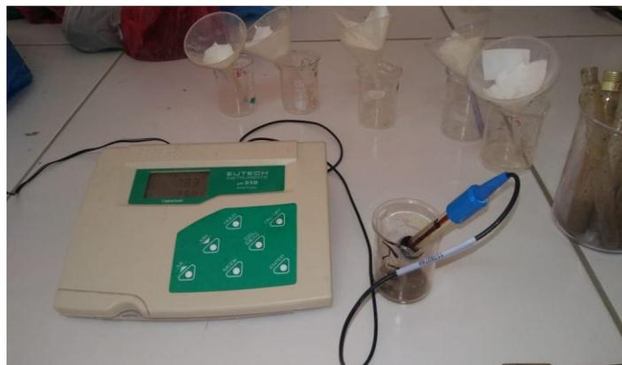
Figure 22 : conductimètre (Photos originale).
