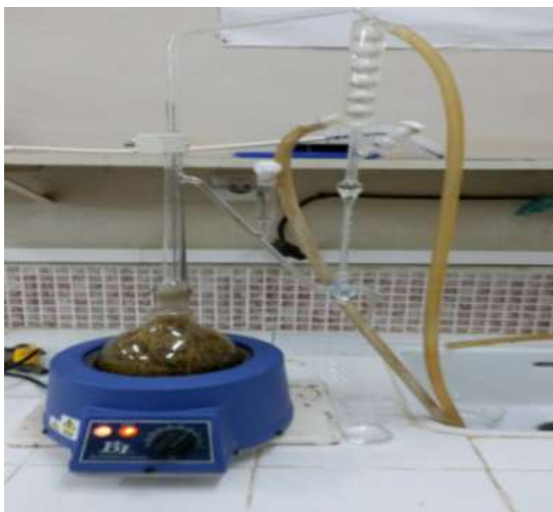
Figure 17 : Technique d'extraction des huiles essentielles par hydrodistillation dans un appareil de type Clevenger.
