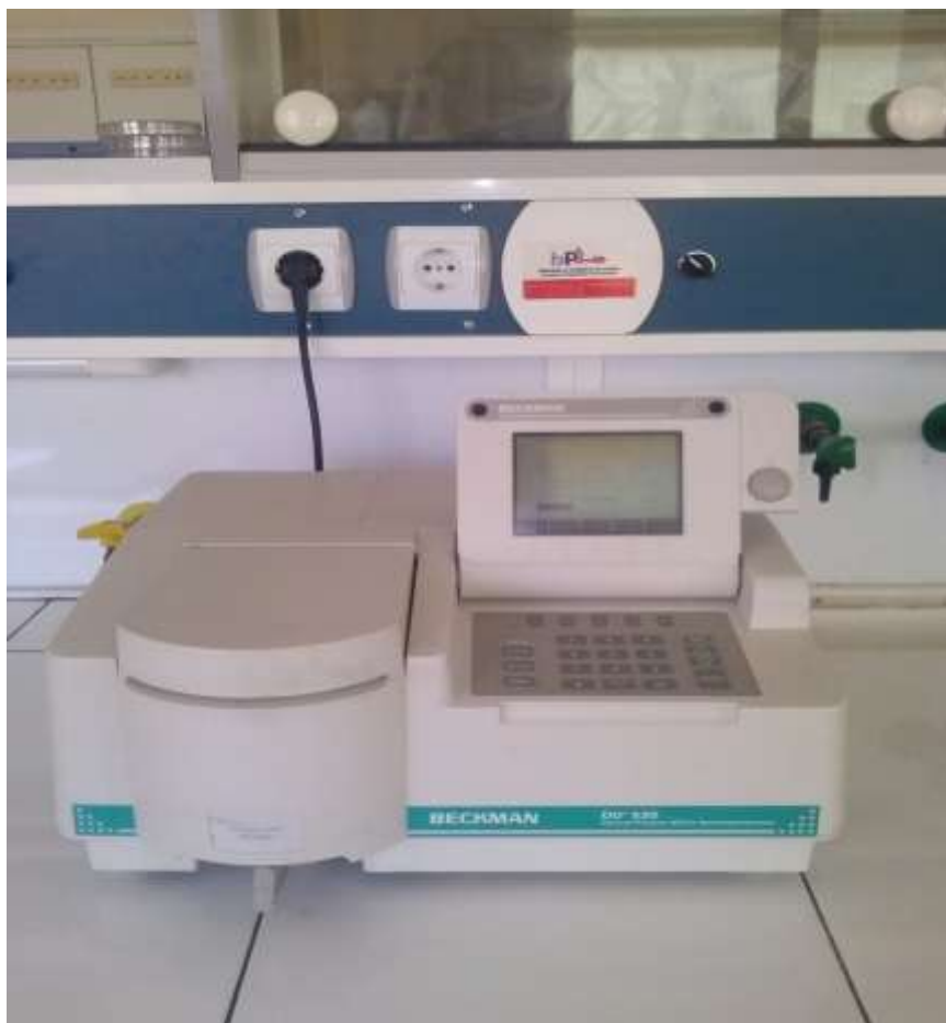
Photo IV.3 : Spectrophotomètre UV. Visible BECKMAN DU 520
