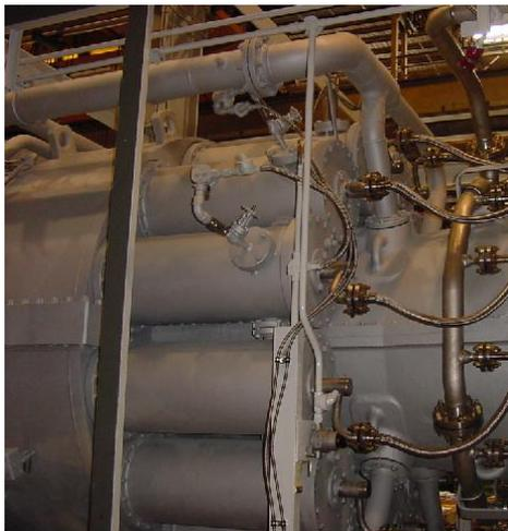
Figure II.3 : Système de combustion standard MS 5002
