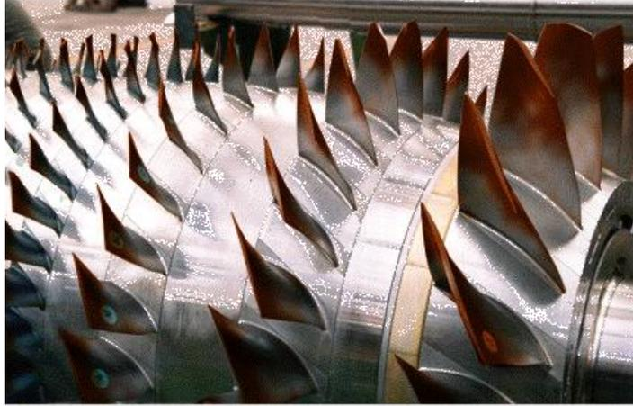
**Figure II.11 : Encrassement du compresseur**
