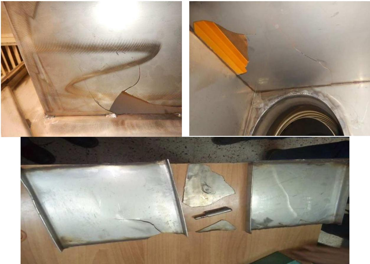
Figure II.13 : Pièces collectées dans le plénum (admission air)
