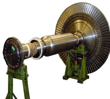
Figures II.4. B : Rotor turbine LP
