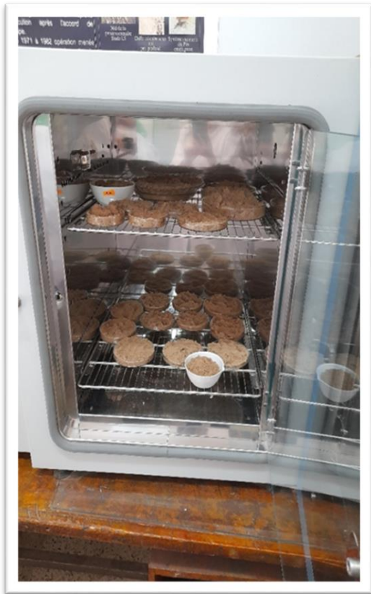
Fig 31 : Stérilisation du sable à l'étuve à 80 °C
