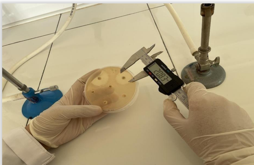
Figure 33 : Mesure des zones d'inhibitions (Photo originale, 2022)
