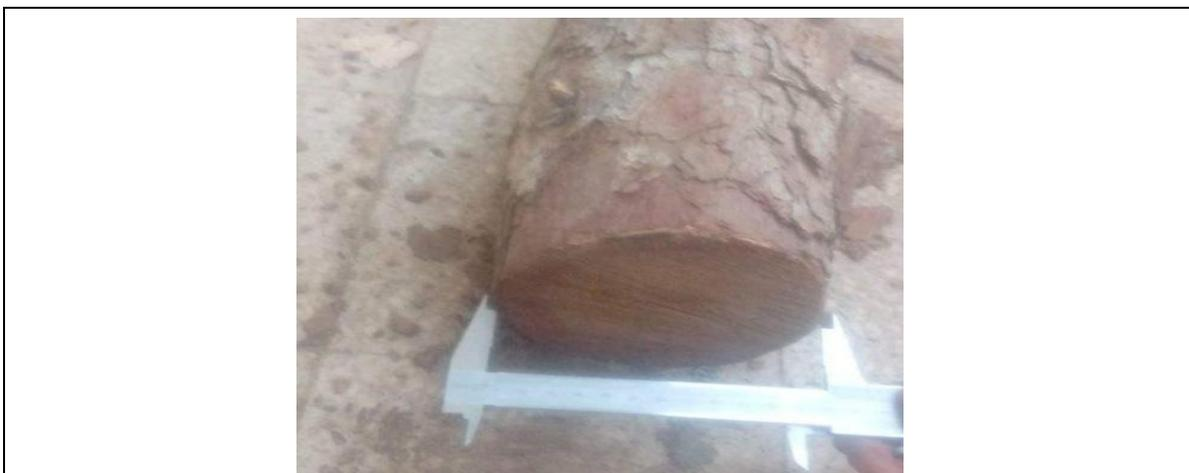
**Figure 21** : Méthode de mesure du diamètre du tronc (Originale).
