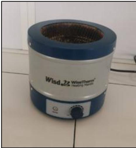
**Figure 3.** Chauffe-ballon électrique
