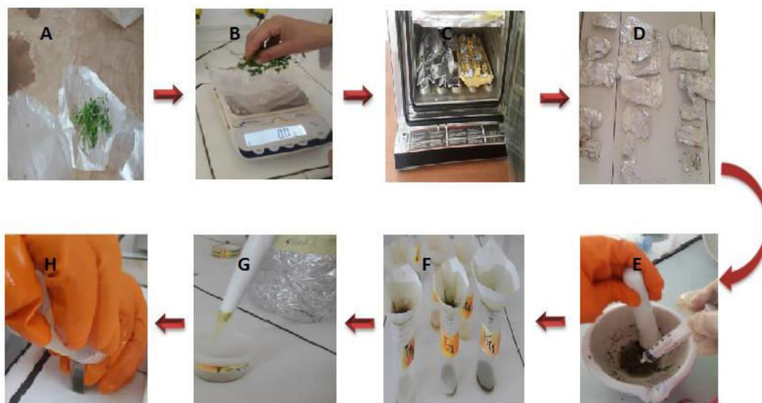
**Figure 7:** Dosage du phosphore par colorimètre Selon (TAUSK et SHORR., 1963). **A:** Découpage des feuilles. **B, C et D :** Poids de matière fraîche et sèche à 70 C°/ 72h. **E :** Mettre 0.1g de matière sèche requis et ajoute 5 ml d' HCl. **F :** Après la centrifugation en récupérant le surnageant et filtrage. **G:** Ajoute 2 ml de réactif sulfomolybdique. **H :** Passage en spectrophotomètre à 650 nm.
