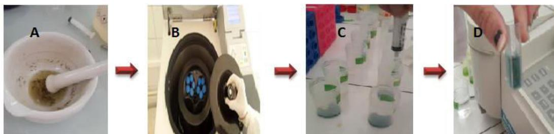
**Figure 6:** Dosage des protéines totales. **A:** Broyage à froid de la matière végétale avec tampon phosphate 0.06M pH 7. **B :** Centrifugation. **C :** Ajoute 2 ml de réactif de Bradford. **D :** Passage en spectrophotomètre après 2 min du développement des réactions.
