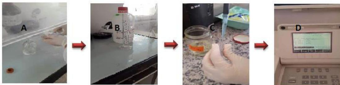
**Figure 12:** Dosage enzymatique de peroxydase. **A et B :** Préparation d'extrait enzymatique. **C :** Ajoute 10 ml d' $H_2O_2$ . **D :** Suivre de la cinétique de l'activité de la peroxydase à 470 nm.
