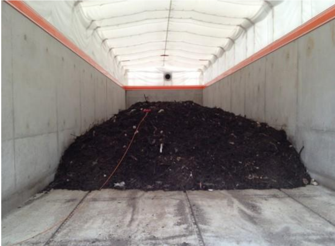
Figure 8: Tunnels fermés statiques aéré.
