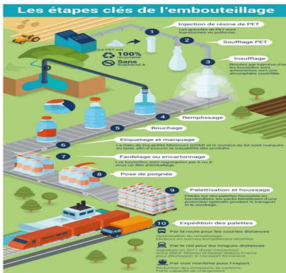
Figure 2: Les étapes de l'embouteillage dans les unités de production des eaux embouteillées (Medfouni, 2019)
