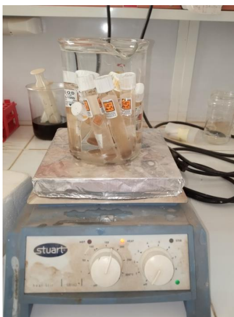
Figure10 : Extraction du chrome hexavalent à partir des échantillons de sol
