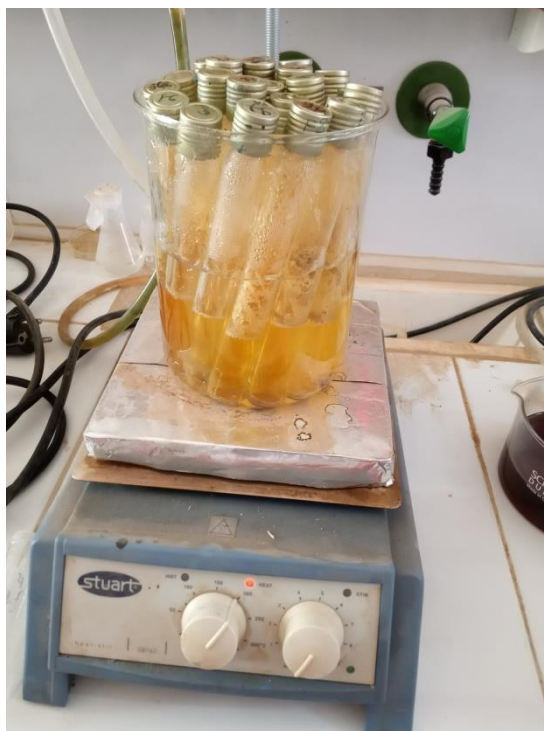
Figure11 : Extraction du chrome hexavalent à partir des échantillons de plantes
