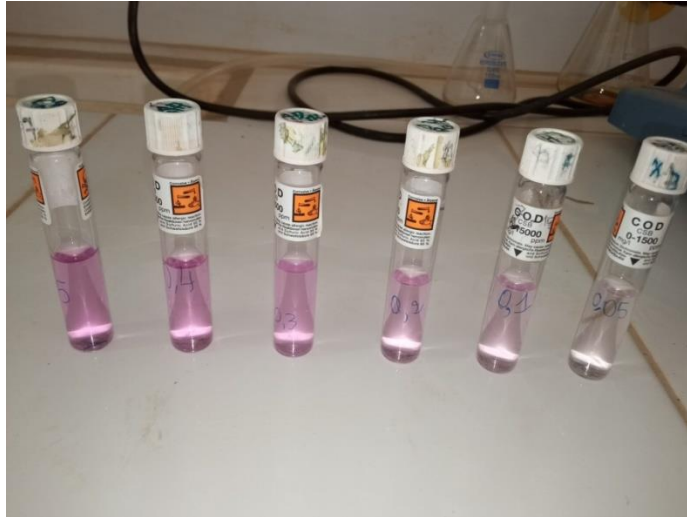
Figure 14 : Solutions standard de chrome hexavalent après contact avec 1.5 Diphenylcarbazide.
