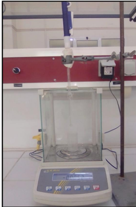
Figure 16: Mesure de la tension superficielle par la méthode stalagmométrique.
