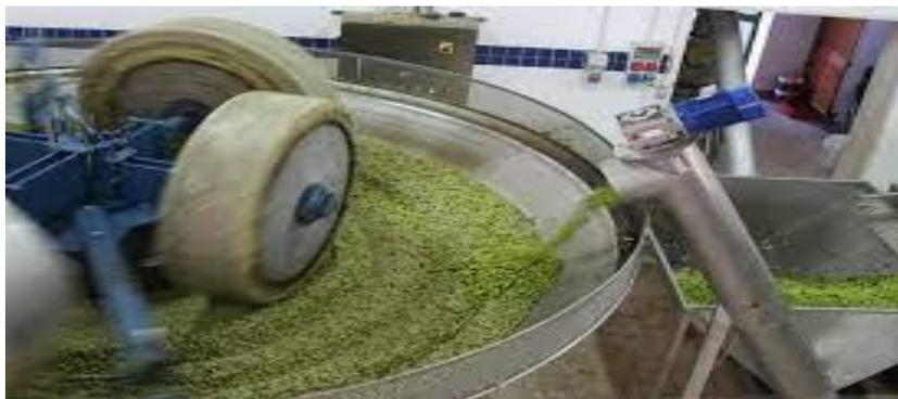
**Figure 7:** Broyeurs à olive. (BoualiSoufyane et al. 2019)
