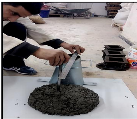
a) Affaissement au cône d'ABRAMS.
