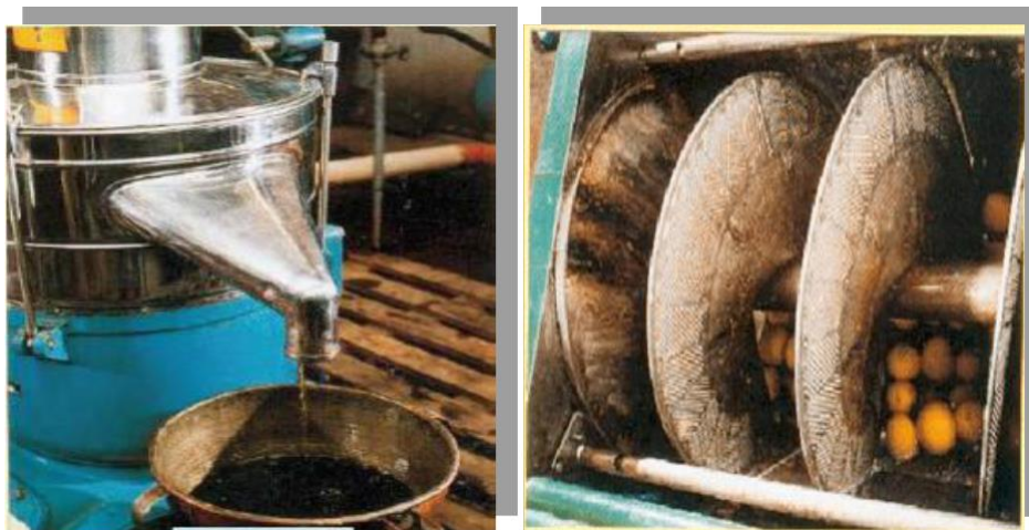
Figure 22 : Photos à gauche d'une Pélatrice et à droite d'une centrifugeuse séparatrice de l'essence de Citrus (Bousbia, 2011)
