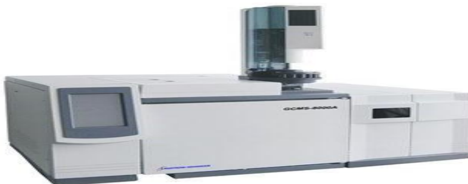
Figure 08 : Chromatographe en Phase Gazeuse (Dhib et al. , 2011).
