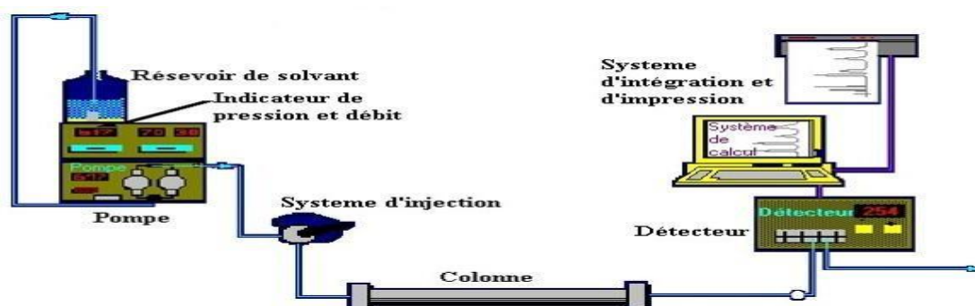
Figure 09 : Composants d'un appareil de chromatographie liquide (Lauranne, 2016).
