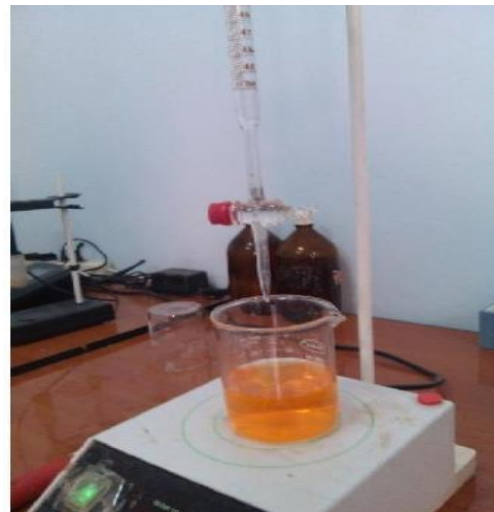
Figure N°17 : photo de titrages de Cl - à la fin (la coloration devient brune).
